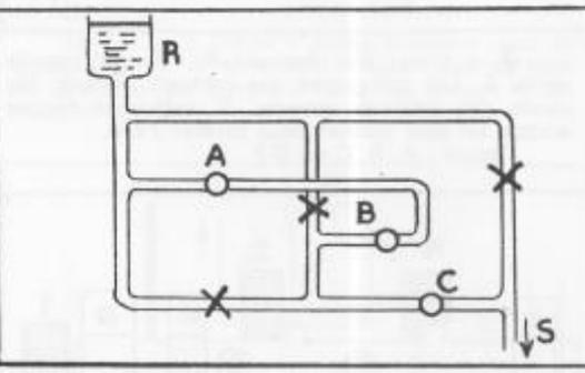
**IV. - L'eau du réservoir R s'écoule par la sortie S. Les croix sont des robinets fermés ; les ronds des robinets ouverts. Il suffit de fermer encore un seul robinet pour arrêter l'eau. Lequel : A, B ou C ? Si on peut arrêter l'eau en fermant n'importe lequel de ces 3 robinets, marquez la réponse D.**
